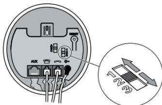
**3.11** Stellen Sie die Übertragungslautstärke über die entsprechende Regelung an der Basisstation ein. Wechseln Sie zwischen den drei Einstellungen, bis die Testperson Ihnen die richtige Lautstärke bestätigt. <sup>1)</sup>
